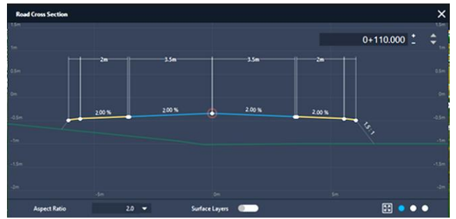
Hình 13. Mặt cắt ngang thể hiện bề mặt thiết kế và tự nhiên
